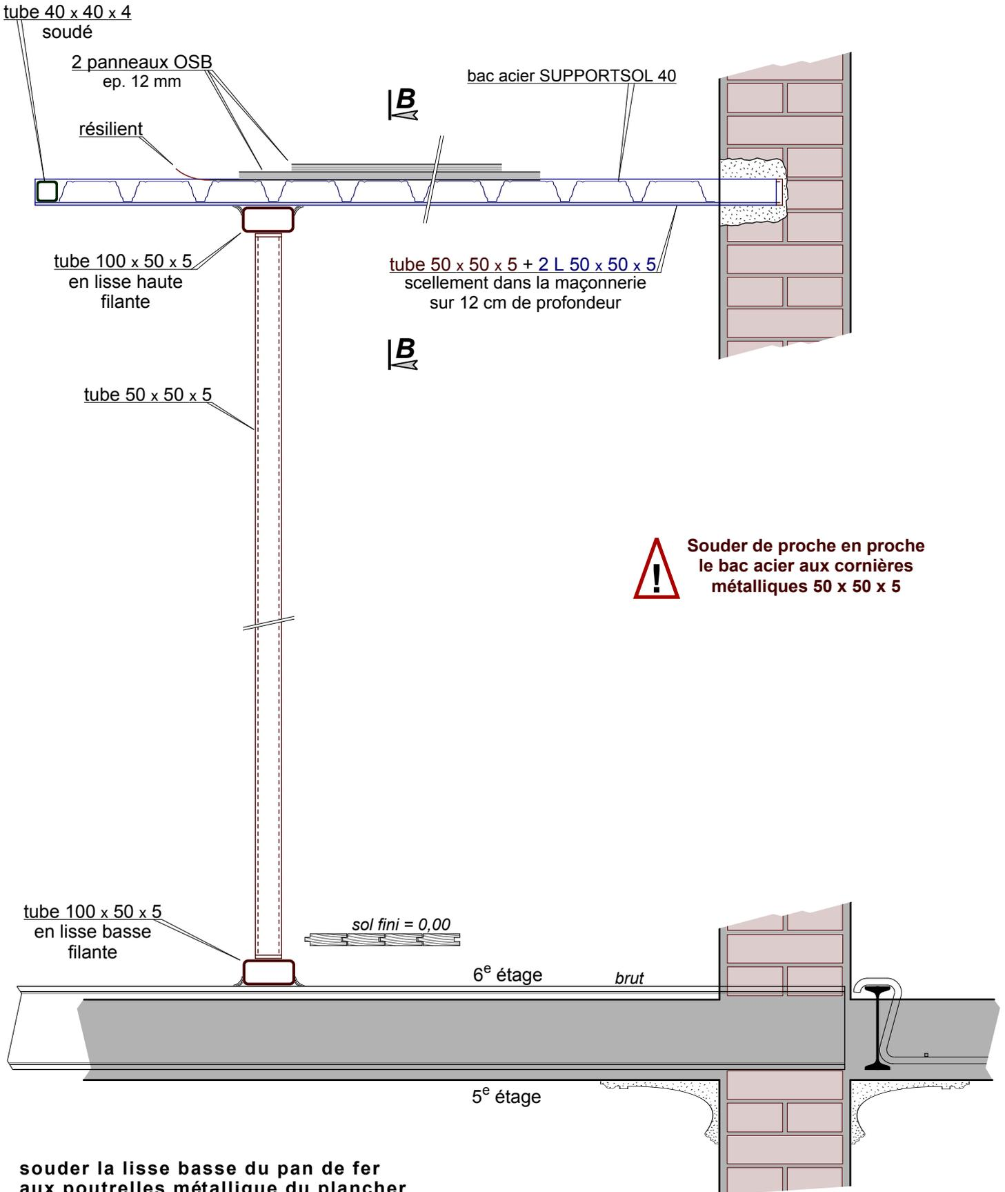
souder la lisse basse du pan de fer aux poutrelles métallique du plancher existant
